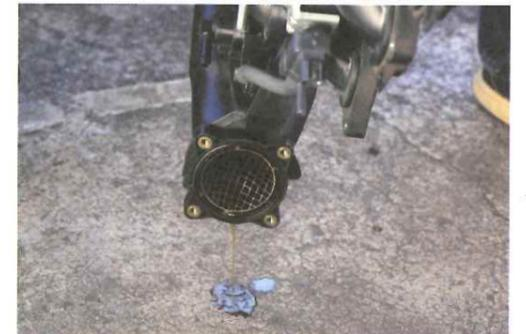
エンジン回転を上げていくと、ボンボンと失火しやすくなるので、インマニを外してみたら内部に液が残っていた。NAガソリンエンジンはインマニが長く複雑なので、いかに分散させるかが施工時の課題。
