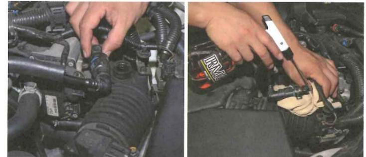
マツダNC型ロードスターでも試したが、スロットル手前のブローパイプから入ると、マニホールドのUターン部に落ち込んで溜まるようだ。またスロットルバルブの汚れにはほとんど変化がみられないので、吸気バルブに近い位置で吹き込むことが重要ということを確認した。
