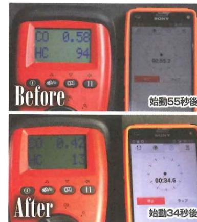
排ガス値の表示は、テールパイプから細いチューブで吸わせるため、十数秒の遅れがあるが、エンジン始動からの時間と排ガス値を比較すると、クリーニング後のほうがピークに達した時間が早く、すぐ収束する。
