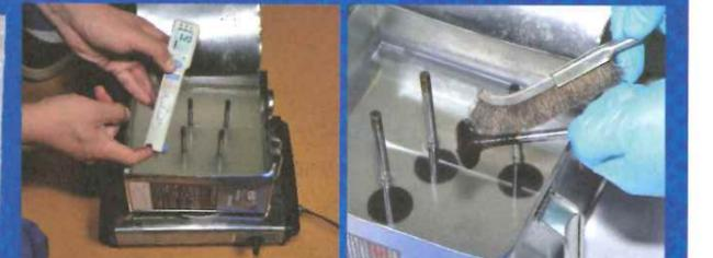
オーバーホール時の部品洗浄で役立つのが、ホッカイスーパーという粉末状の洗浄剤。写真は10gのものだが、2Lのぬるま湯に溶かして一晩放置後、液を60℃程度に加熱してパーツを漬け込む。その後ブラッシングして汚れを落とす。即効性ではないが、安全性が高く生分解性を持っており排水の中和も不要。
