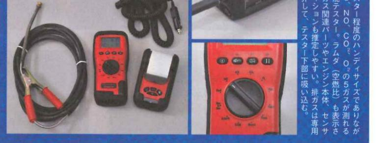
サーキットテスター程度のハンディサイズでありながら、CO、HC、NO、CO<sub>2</sub>、O<sub>2</sub>の5ガスが測れるという、高性能テスター。ラムダ (空燃比) も表示されるので、排ガス関連パーツやエンジン本体、センサー等のコンディションも推定しやすい。排ガスは専用のチューブを介して、テスター下部に吸い込む。
